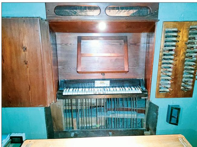
innestate le canne) e i meccanismi di trasmissione (il nostro organo è a trasmissione meccanica), costituiti in primis da bilancieri, leve e molle con il compito di trasferire il movimento di azionamento di tasti e registri in aperture (tramite valvole) al passaggio dell'aria delle corrispondenti canne.
